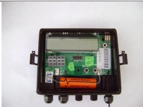
Подключить мультиметр в режиме измерения тока между выводом «+» батареи и контактной площадкой, к которой должен быть подключен данный вывод.
