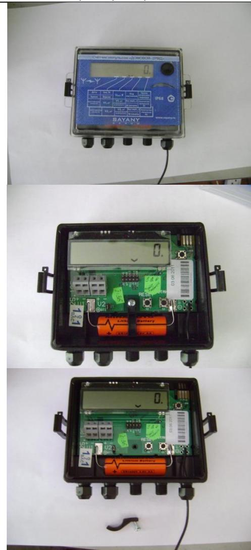
Выпаять батарею из платы, запомнив полярность ее подключения. Выводы новой батареи отформовать и обрезать аналогично извлеченной.
