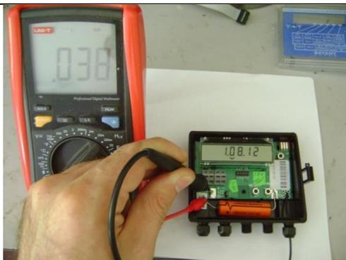
Если измеренный ток не превышает указанное значение, то вывод «+» батареи припаивается к соответствующей контактной площадке. В противном случае прибор подлежит ремонту в условиях сервисного центра.
