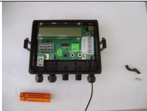
Припаять вывод «-» новой батареи к соответствующей контактной площадке. Вывод «+» оставить неподключенным.
