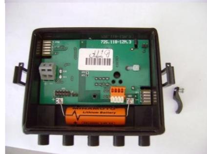
Выпаять батарею из платы, запомнив полярность ее подключения. Выводы новой батареи отформовать и обрезать аналогично извлеченной.
